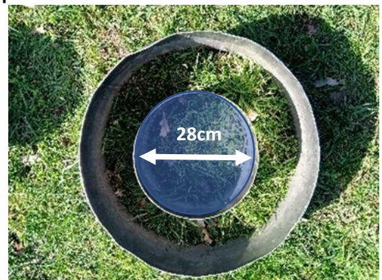
Figuur 18 binnenste ring dubbele ringinfiltrometer
